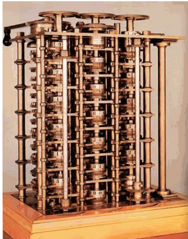
Een deel van de gereconstrueerde Difference Engine van Charles Babbage
